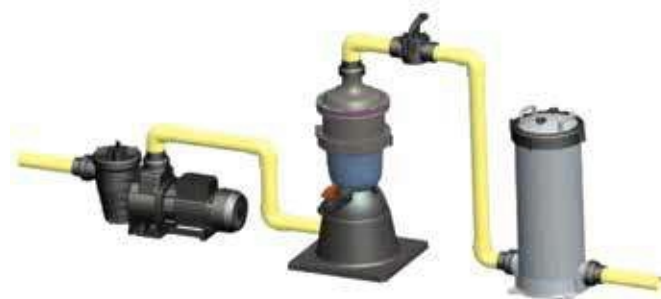
Instalação em base Multicyclone
